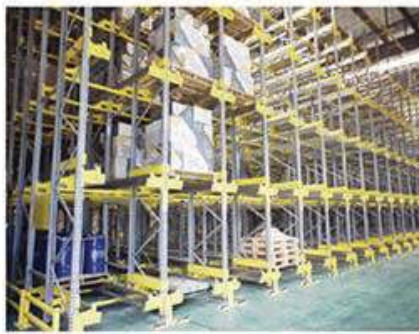
การจัดเก็บด้วยระบบรถรับส่ง ผ่านสัญญาณวิทยุ Radio Shuttle System
